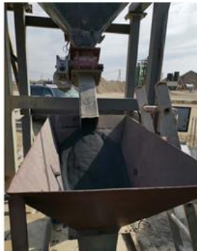
УСТАНОВКА ДЛЯ ПРИГОТОВЛЕНИЯ РПБВ-90 МОКРЫМ СПОСОБОМ НЕПОСРЕДСТВЕННО НА БИТУМНОМ УЧАСТКЕ АБЗ
